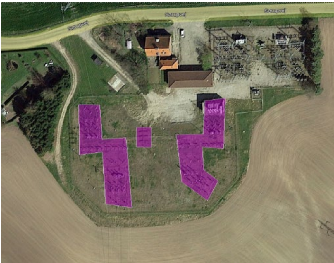
Figur 4: Skitsering af anlægsarbejder: Nedrivning af eksisterende transformerstation, på de med lilla markerede arealer.
